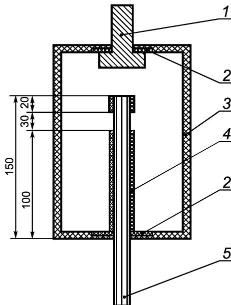
1 — стержень для захвата в зажиме разрывной машины; 2 — упорный подшипник; 3 — корпус устройства; 4 — изоляция;
